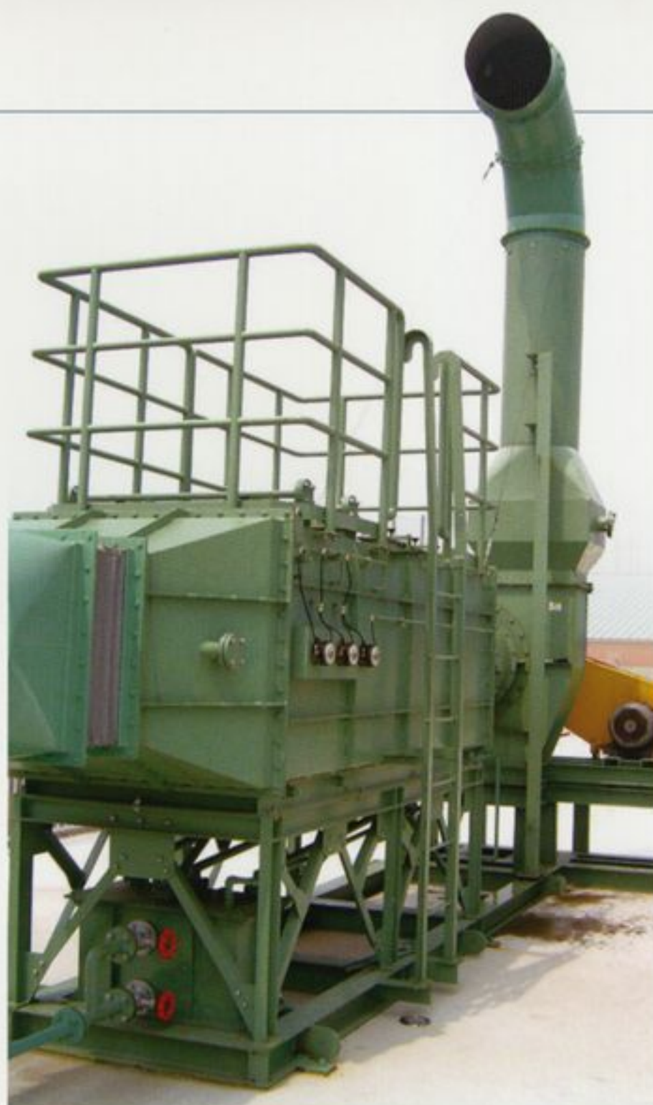
奈良県某社へ納入したミストコレクター 350m 3 /min 切削油から出るオイルミストを集中排気
